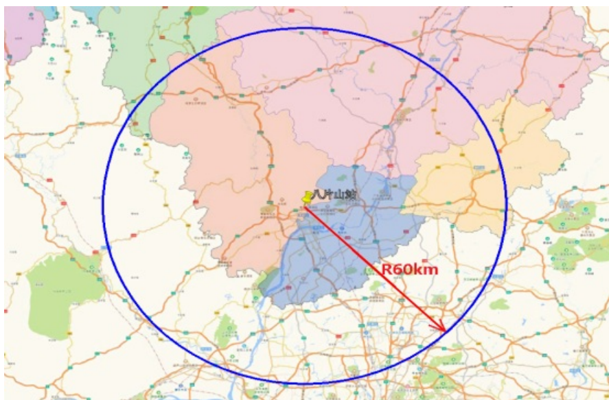
图1 清远市清城区X波段双极化相控阵天气雷达覆盖范围示图
